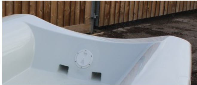
Figure 2 : Tableau arrière du Rondar
